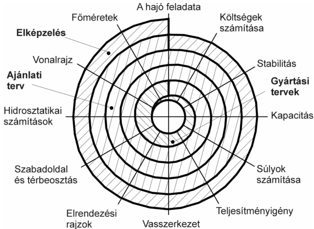
2.2.1 ábra A hajótervezés folyamatának spirális diagramja
