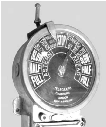
4.2.1.1.6.8 ábra Mechanikusan működtetett géptelegráf
