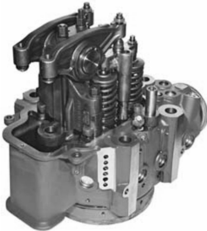
4.2.1.2.3 ábra A MAK551 V12 négyütemű dízelmotor hengerfeje
